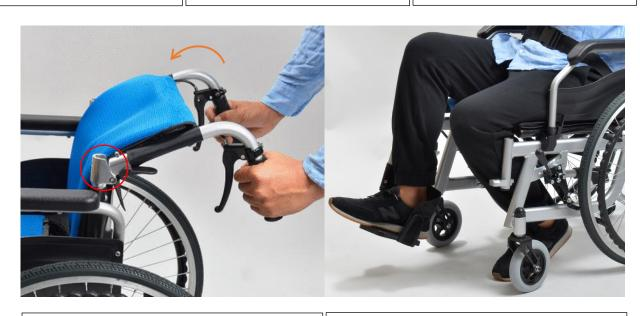
③ 押手部分を持ち、上方へ持ち上げます。 ※背折れ金具が完全にロックされていることを確認して ください。 ④ ご利用者が車椅子に乗車後、ステップ板を下ろしてください。
