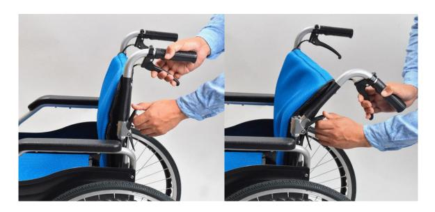
① 平坦な場所で駐車ブレーキをかけ、ステップ板を上方へ跳ね上げ、ご利用者はアームサポートを持ちゆっくりと立ち上がります。押手部分を片手で持ち、背折れ金具のレバーを後方へ引き背もたれを倒します。
